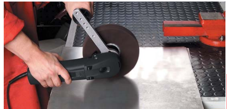
Обработка металла шлифовальный круг из нетканого материала и рукоятка (принадлежности)
