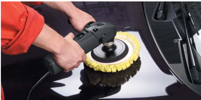
Обработка лакокрасочной поверхности автомобиля полировальный диск Super, Ø 200 мм (принадлежность)
