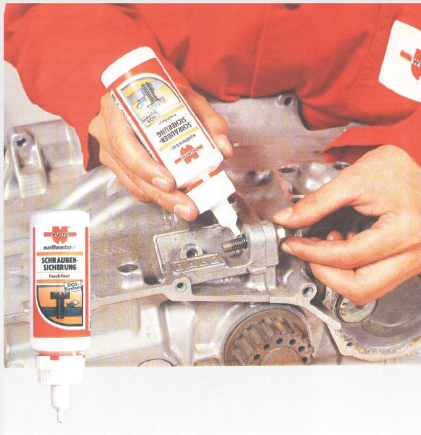
Для герметизации и фиксации болтов, распорных шпилек, гаек, резьбовых вставок, резьбовых пробок, которые должны быть надёжно зафиксированы.
